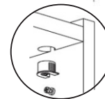
Схема крепления стяжки эксцентриковой усиленной
